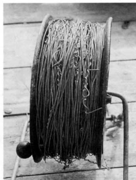
Abb. 9. Nebst einem Spannungsabfall durch den erhöhten Leiterwiderstand sind durch die vielen unsachgemässen Flickstellen Verletzungen an der Hand beim Aufstellen und Abbrechen des Zauns zu befürchten.
