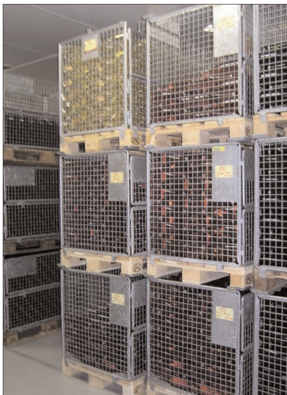
Abb. 3: Platz und Kosten sparende Versetzung dank Wegfall der Rüttelpulte.
