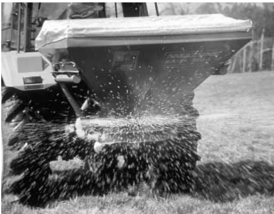
Abb. 1: Moderne Zweischeibenstreuer ermöglichen heute das exakte Ausbringen von Mineraldüngern in der gewünschten Streumenge und mit hoher Streugenaugkeit.
