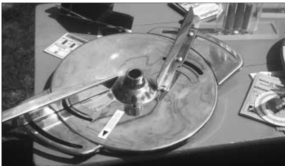
Abb. 3: Alle geprüften Streuer arbeiten mit unterschiedlichen Arbeitsbreiten. Die Anpassung der Arbeitsbreite erfolgt durch Verwendung verschiedener Streuscheiben, durch Auswechseln der Wurfschaufeln oder durch Änderung der Wurfschaufelposition. Die Streutabelle vermittelt die Angabe der richtigen Einstellung.
