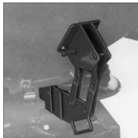
Abb. 6: Für das Streuen bei nahem Abstand der Fahrgasse zur Feldgrenze verwenden die meisten Hersteller eine Grenzstreuplatte, die von Hand oder hydraulisch heruntergeklappt wird. Bei Streuern mit geteiltem Behälter muss zudem die Auslauföffnung über der linken oder rechten Streuscheibe geschlossen werden.
