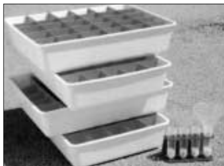
Abb. 7: Mit einem solchen Praxis-Prüfset lässt sich die Streugenauigkeit im Feld überprüfen. Die Verwendung empfiehlt sich, wenn Dünger mit unbekannter Herkunft gestreut werden.
