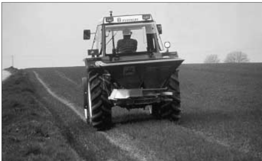
Abb. 2: Nur mit einer Grenzstreuervorrichtung ist es möglich, mit einem Schleuderdünger den Dünger entlang von Feldrändern gleichmässig und ohne hohe Verluste auszubringen.
