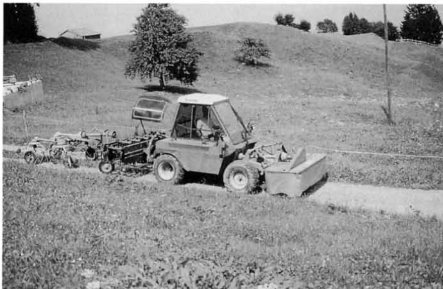
Abb. 1. Zwei Anbauräume (Front- und Heckhubwerk) sind vor allem bei grösseren Feldentfernungen arbeitswirtschaftlich interessant. Damit können zwei oder gar drei Arbeitsgeräte gleichzeitig auf das Feld geführt werden.
