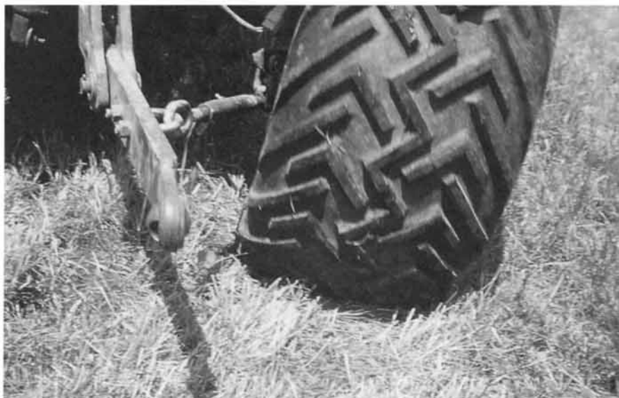
Abb. 4. Der flexible Terrareifen erträgt relativ hohe Abtrift- und Schlupfwerte, bis die ersten Bodenschäden sichtbar werden.
