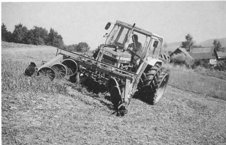
Abb. 2. Der Traktor mit Doppelrädern weist eine hohe Hangstabilität auf. Die Einsatzgrenze ist durch die Forderung nach bodenschonender Arbeit bei rund 35% Hangneigung gegeben.
