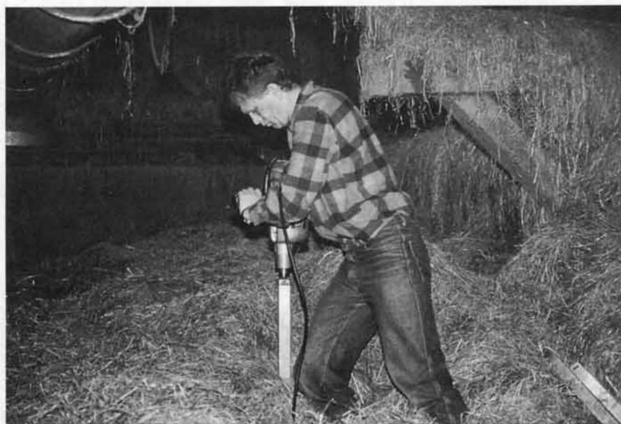
Abb. 1. Zum Bohren der Heustockproben diente eine elektrisch betriebene Sonde, die einen Zylinder mit einem Durchmesser von zirka 75 mm herauschnitt.
