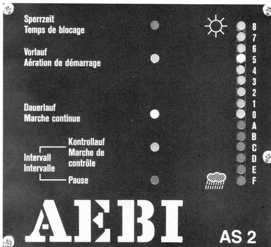
Fig. 1. Appareil de commande qui mesure la température de l'air à l'entrée du ventilateur et à la surface du tas de foin.
