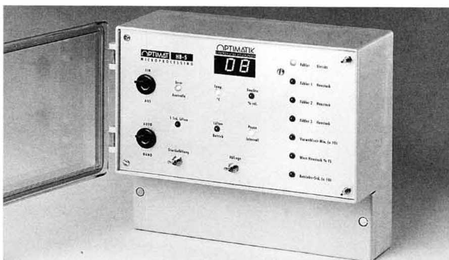
Fig. 2. Cet appareil contrôle la température et l'humidité de l'air près de la buse d'aspiration du ventilateur et à 1–3 endroits au-dessus du tas.
