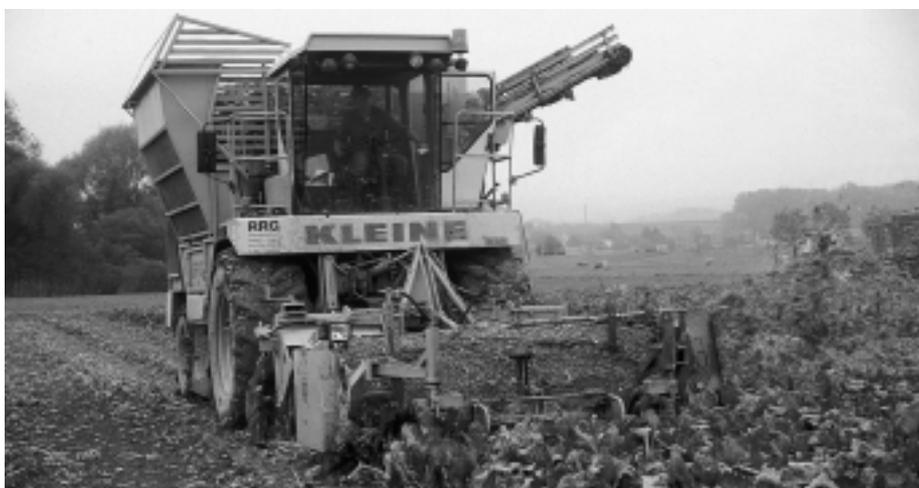
Fig. 1: Les récolteuses totales automotrices de betteraves sucrières ont remis sur le tapis la discussion concernant la charge exercée par les machines sur le terrain et le tassement des sols.
