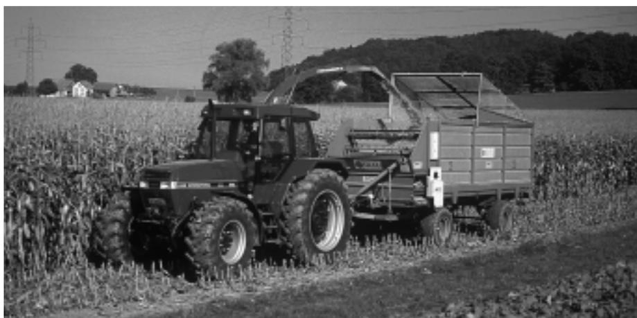
**Fig. 11: La performance à la surface d'une ensileuse à maïs portée dépend en premier lieu de la puissance du tracteur. Lorsque les tracteurs sont suffisamment puissants, les ensileuses à maïs portées peuvent s'avérer très compétitives.**
