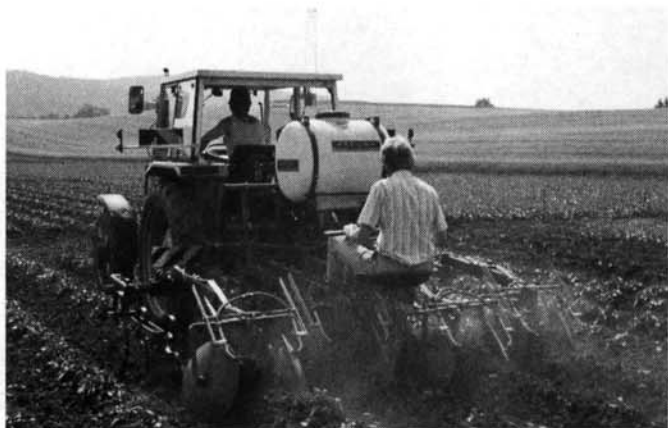
Abb. 1. Mit der Vielfachgeräte-Kombination lassen sich die drei Ziele wie Dammaufbau, Bodenpflege und eine wirksame Unkrautregulierung (rechts) erreichen.
