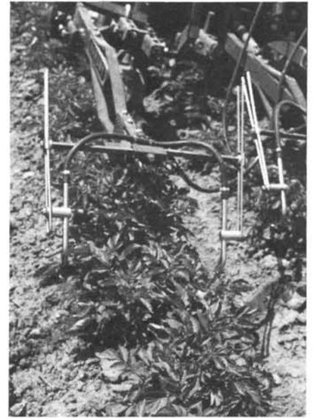
Abb. 5. Die Bandspritzung mit zwei Excenter-Flachstrahldüsen (Teejet OC-02) pro Reihe war in allen Versuchsjahren erfolgreich. Links/rechts: Sencor- oder Titusausbringung.
