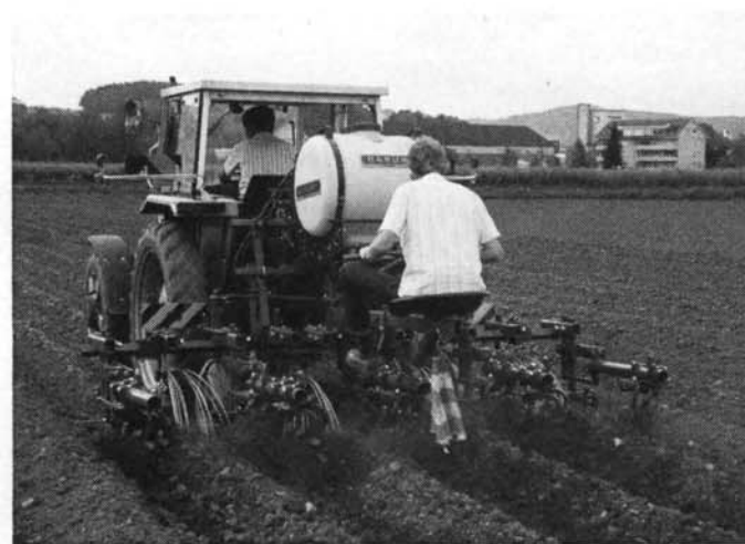
Abb. 4. Die Sternhackgeräte-Kombination zeichnete sich durch eine gute Bodenlockerung und -krümelung sowie eine wirksame Unkrautregulierung aus. Erster und dritter Arbeitsgang bei einer günstigen Bodenfeuchtigkeit.
