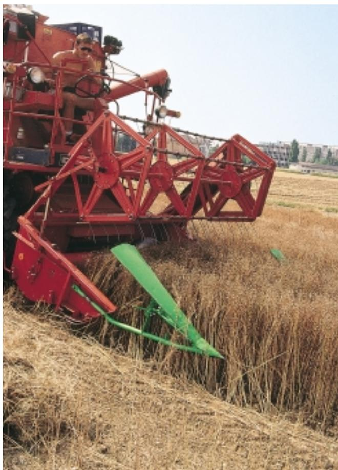
La récolte est grandement facilitée lorsque les tiges sont bien sèches et que le temps est ensoleillé et chaud. La lame de la barre de coupe doit être en parfait état. C'est souvent au niveau de la vis d'alimentation que se rencontrent des difficultés. Si le diamètre de la vis est trop faible, le lin aura tendance à s'enrouler autour. Concernant les doigts escamotables, un réglage de l'excentrique les fera rentrer au maximum.
