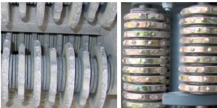
Abbildung 1: Kombination von Rund- und Achtkantlamellen für das Rillieren und Aufrauen in Längsrichtung (links), Rundlamellen für das Aufrauen und feine Rillieren in Querrichtung (rechts).
