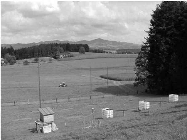
**Abb. 2. Feldversuch im Wassereinzugsgebiet des Greifensees: Monitoring von P-Verlusten im Oberflächenabfluss auf der Versuchsfläche bei Grüningen (Foto: Michael Schärer, ETHZ).**
