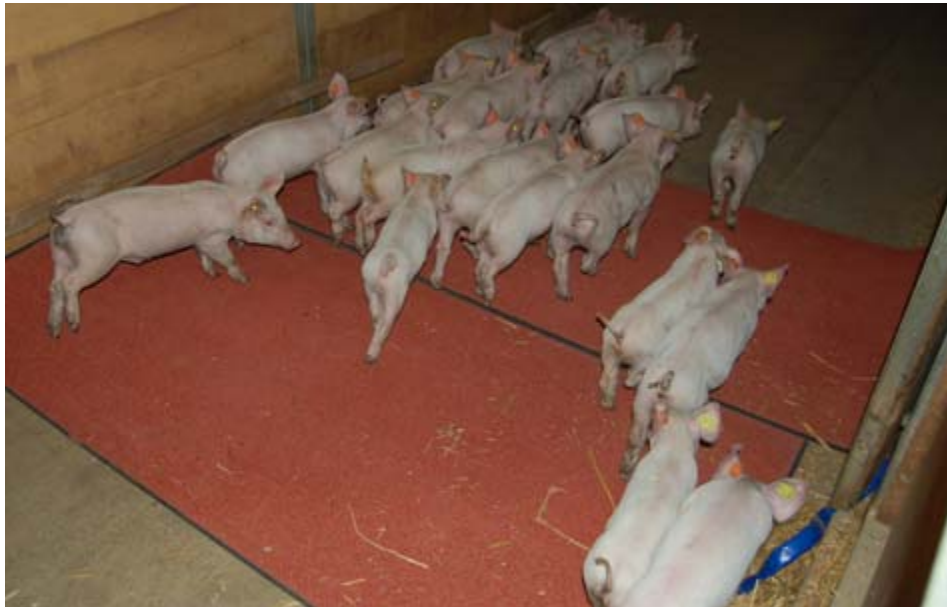
Abb. 2: Zwei Kunststoffmatten mit jeweils einer Sende- und vier Empfangsschleifen
