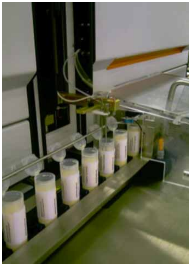
Figure 6: Analyse du lait par spectrométrie infrarouge (appareil Combifoss FC) chez Suisselab, Zollikofen BE
