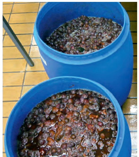
Abb. 1: Die Gärfässer in der Brennerei bei einer Raumtemperatur von 17 °C.
