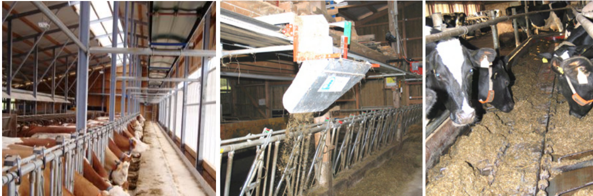
Abb. 2: Futterbänder legen einzelne Futterkomponenten oder Mischungen vor. Sie sind entweder über Kopfhöhe (links und Mitte) oder in der Krippe (rechts) angebracht. Sie sind entweder bei Neuerstellung direkt einbau- (links und Mitte) oder nachrüstbar.
