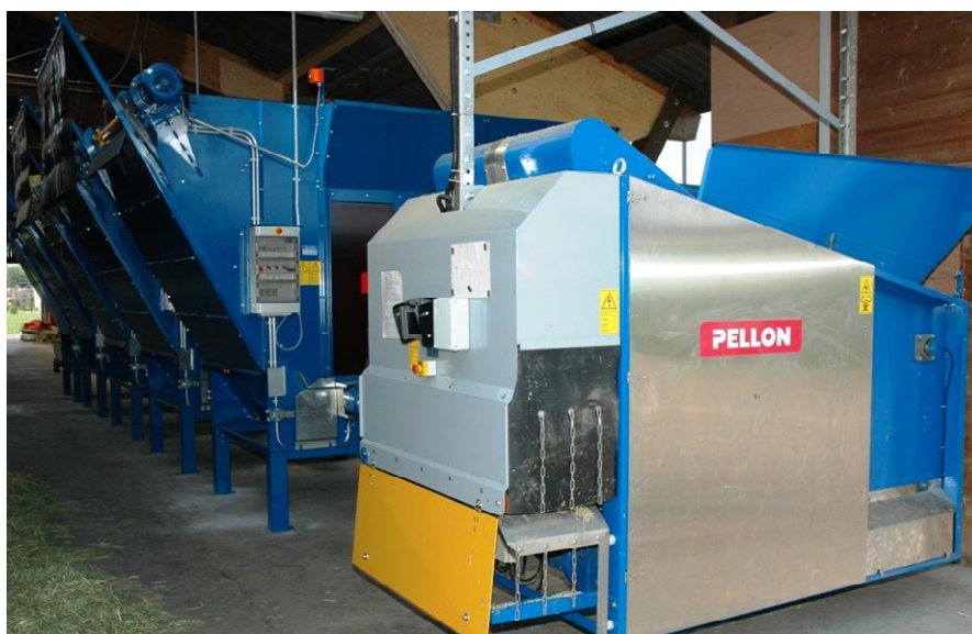
Abb. 3. Schienengeführtes, automatisches Fütterungssystem mit Vorratsbehälter
