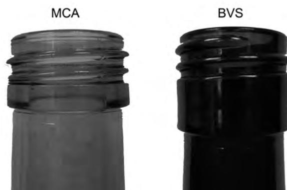
Abb. 2: Darstellung verschiedener Flaschenmündungen: MCA-Mündung und BVS-Mündung.
