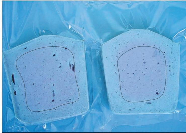
Campione trattato con azoto (a sin.) e campione di controllo (destra) dopo 24 ore di esposizione alla luce.
