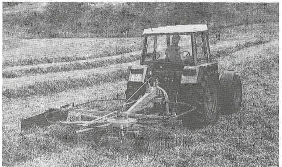
Abb. 1: Der Kreiselschwader ist noch immer die verbreitetste Schwadmaschine.
