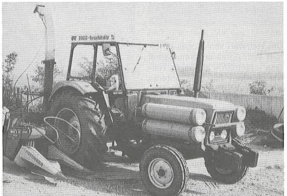
Abb. 1: Auf Biogasbetrieb umgerüsteter Versuchstraktor.
