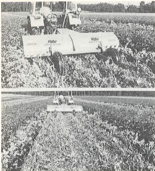
Abb. 4: Mit dem vierreihigen Zinkenkrautschläger Gruse (Müller, Bättwil) werden die Stauden auf eine über die Stützräder einstellbare Höhe abgeschlagen und die Stengel aufgeschlitzt. Infolge Fehlens der Leitbleche deckt ein Teil des abgeschlagenen Krautes (auch bei Kettenschläger) die Reststengel zu, was die Präparatanlagerung erschwert.
