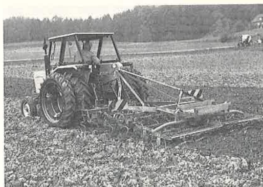
Abb. 7: Mit der Doppelbereifung konnte der Schlupf massgebend verringert werden.
