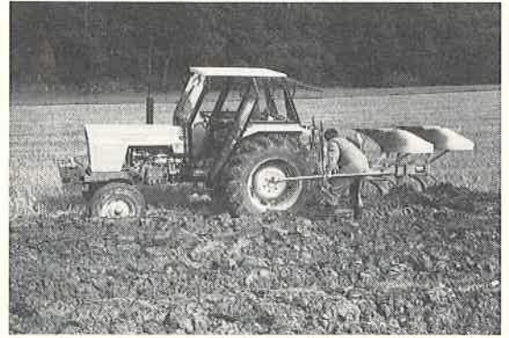
Abb. 5: Beim Pflügen konnte mit dem stärkeren Normaltraktor in praktisch allen Einsätzen in einem um eine Stufe höheren Gang gefahren werden.
