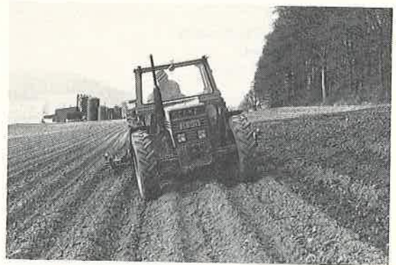
Abb. 11: Beim Hangackerbau wurden mit Allradantrieb kleinere Schlupf- und Abtriftwerte gemessen.
