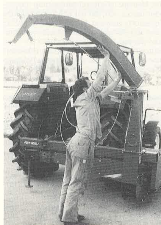
Abb. 5: Das Auswurfrohr soll bei allen Maishäckslern auf halber Höhe abklappbar sein.
