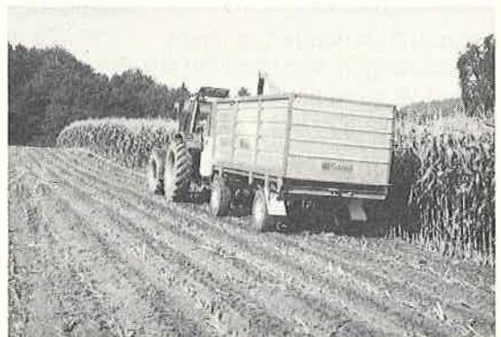
Abb. 1: Auch mit einem billigen, einreihigen Maishäcksler ist eine beachtliche Flächenleistung möglich.
