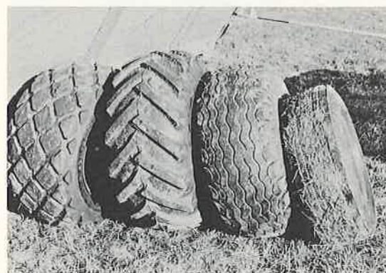
Abb. 6: In bezug auf die Seitenführung und das Bremsvermögen untersuchte Reifen. Von links nach rechts: 15.0/55-17 mit Golf-, Stollen- und Rillenprofil; 10.5-16 mit Längsrillen.
