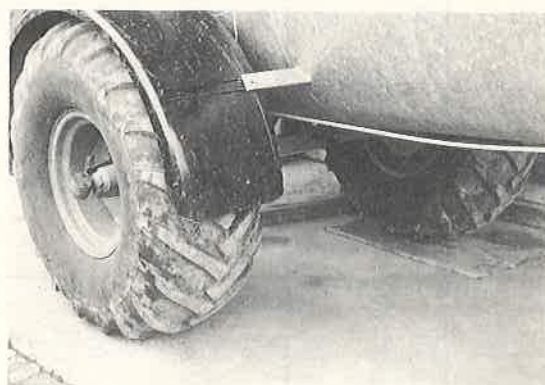
Abb. 2: Grossvolumige Bereifung (20.0/70-20) eines Druckfasses. Arbeitsanhänger sollten grossvolumig bereift werden, damit bei einem Reifendruck von 2,5 bar und weniger bereits ein ausreichendes Tragvermögen vorhanden ist.
