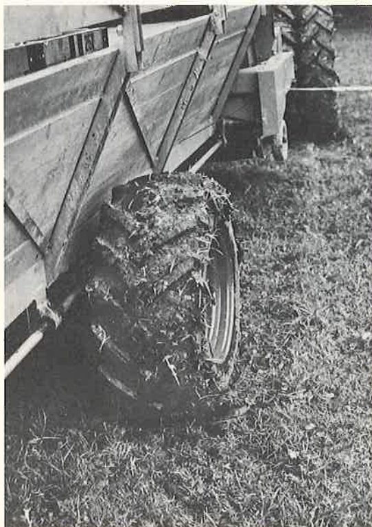
Abb. 8: Ladewagen mit AS-Reifen. Für eine gute Selbstreinigung beim Bremsen ist das Profil in umgekehrter Laufrichtung montiert.
