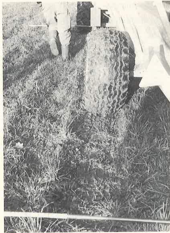
Abb. 5: Abtritt-Messungen. Es wird das seitliche Rutschen der Anhängerräder bezogen auf die Traktorspur registriert.
