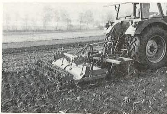
Abb. 3: Wird ein Grubber mit einer Fräse als Nachlaufgerät ausgerüstet, so lässt sich das Feld unter Umständen in einem Durchgang saarfertig bestellen. Eine solche Kombination erfordert allerdings Traktoren über 59 kW (80 PS) Motorleistung.
