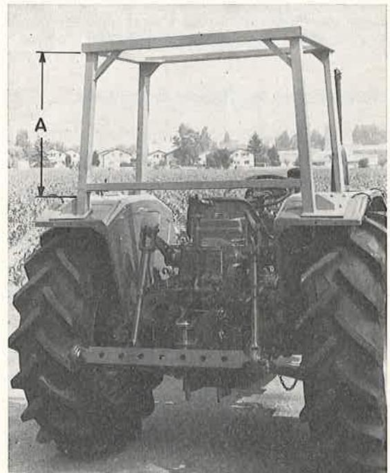
Abb. 1: Sicherheitsrahmen mit vier Stützen. Es ist notwendig, eine ausreichende Höhe für den Beifahrer einzuhalten.
