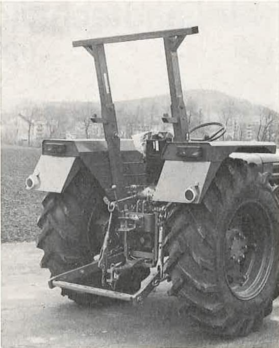
Abb. 2: Ein genügend hoch gebauter Sicherheitsbügel (der Freiraum für den Fahrer bleibt erhalten). Die Bügelhöhe über dem Kotflügel beträgt 920 mm.
