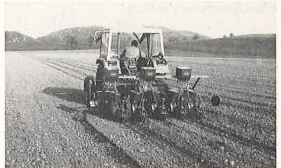
Abb. 3: Nach dem Unterdrucksystem konzipierte pneumatische Einzelkornsägeräte eignen sich sowohl für die Saat auf Wechselabstände wie auch zur Erzielung von doppelt belegten Pflanzenstellen.
