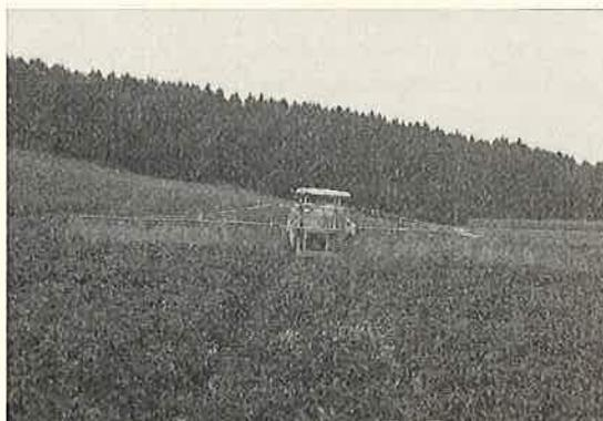
Abb. 2: Feldspritze im Kartoffelfeld. Bei dieser Arbeit sind die Arbeitsbreite und die -geschwindigkeit durch die Konstruktion der Maschine und durch die Ausbringungsmenge des Pflanzenschutzmittels vorausbestimmt. Der Maschinenführer hat durch exakte Einhaltung von Arbeitsdruck der Spritze und Fahrgeschwindigkeit für eine genaue Dosierung des Pflanzenschutzmittels zu sorgen. Rationelle Arbeit dank grosser Arbeitsbreite!
