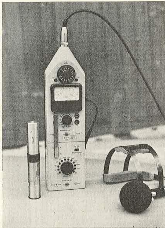
Abb. 3: Schallpegelmessereinrichtung speziell für Lärm-messungen am Ohr des Bedienungsmannes von landwirtschaftlichen Maschinen und Fahrzeugen. (Foto-FAT)
