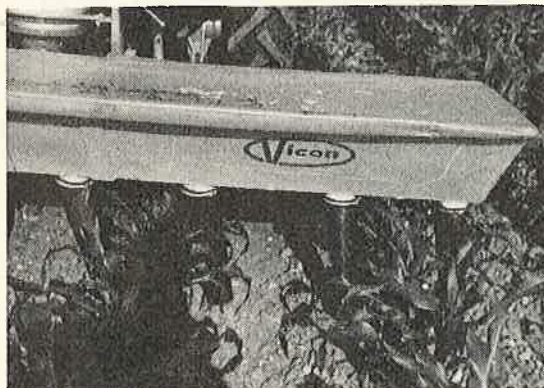
Abb. 4b Detailaufnahme des Reihenstreuers Vicom. Der Dünger wird im Gegensatz zu den übrigen Fabrikaten beidseitig der Pflanzenreihen ausgebracht.
