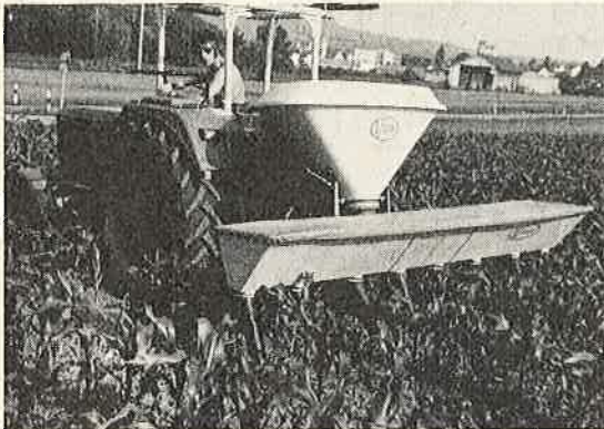
Abb. 4a: Pendelstreuer Vicom mit vierreihiger Streuvorrichtung.
