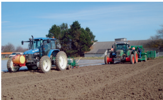
Abb. 1, oben: israelische Field Power Unit (FPU) mit 5,80m Arbeitsbreite und um 90 ° schwenkbaren Rädern. Im Feld wird in Quer- und auf der Strasse in Längsrichtung gefahren. Unten: Traktoren mit verbreiteter Spur im holländischen Gemüsebau. Quelle: Chamen, Pedersen
