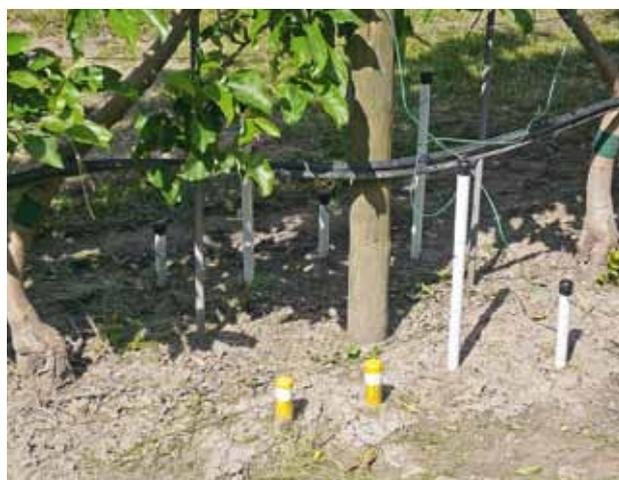
**Figure 2** | Disposition des sondes Watermark (en blanc) dans la parcelle expérimentale.
