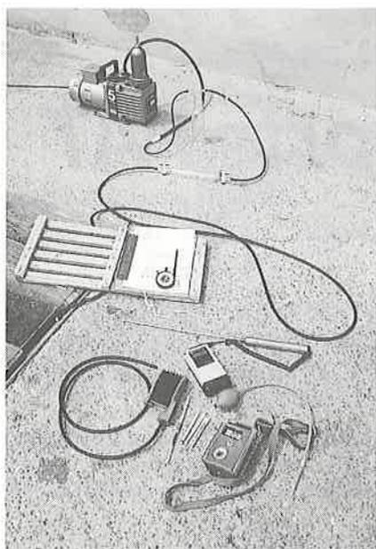
Fig. 2: Quelques-uns des instruments de mesure utilisés. Au second plan, prélèvement de gaz pour échantillonnage au chromatographe en phase gazeuse, au premier plan un tube fumigène, un thermomètre et un appareil de mesure du H<sub>2</sub>S.
