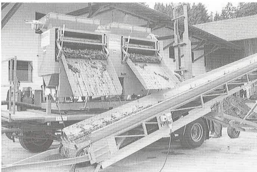
Fig. 2: Presse à tambour tamiseur (système mobile).
