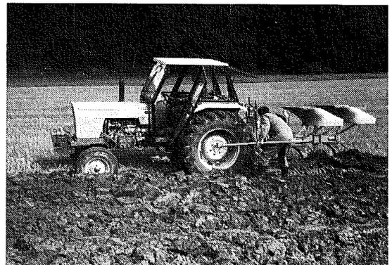
Fig. 5: Lors du labourage, le tracteur normal plus puissant, dans pratiquement tous les cas, a pu être engagé avec un rapport de boîte immédiatement supérieur.
