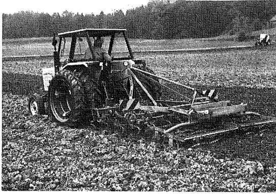
Fig. 7: Les pneumatiques jumelés ont permis de réduire le glissement dans une proportion décisive.
