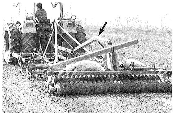
Fig. 3: L'essai de rouleau combiné à un cultivateur fin, pour la préparation du lit de semences de betteraves sucrières en sol marécageux, s'est déroulé dans des conditions optimales. Le long timon coudé du Cambridge (à gauche) permet pratiquement d'atteler toutes les machines (à droite: rouleau d'incision) également à une herse légère.
