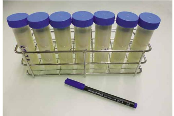
Abb. 7: Ein Gestell stellt sicher, dass die Luft beim Einfrieren zwischen den Probengefässen zirkulieren kann und die Proben nicht umkippen.
