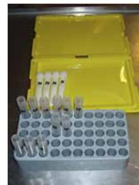
Abb. 2: In der Romandie oft verwendete 13 ml PP-Röhrchen mit Lagerschachtel (hinten) und Kühlblock zur Sofortkühlung (vorne)
