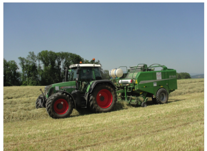
Abb. 2 Heupressen mit einem Konservierungsmittel auf der Ballenpresse
