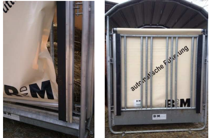
Abb. 6: Funktionalitätsstörungen des Schliessvorgangs
