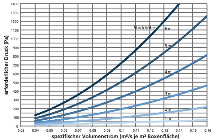
Abb. 6: Statischer Druck bei Wiesenheu in Boxen.
