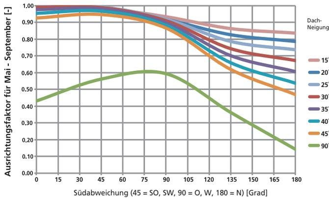
Abb. 12: Ausrichtungsfaktoren gegenüber Südrichtung für die Sommermonate.
