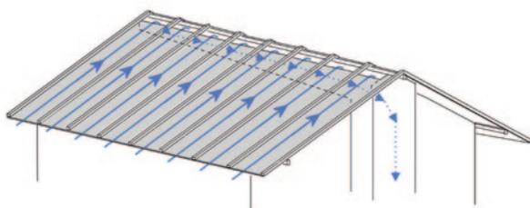
Abb. 8: Sonnenkollektor (Dachabsaugung) bei Sparrendach mit oben liegendem Sammelkanal.
