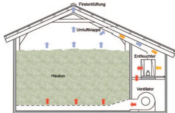
Abb. 19: Schema einer Luftentfeuchtung im Hauptstrom mit Umschaltklappe (Luftfluss s. Pfeile).
