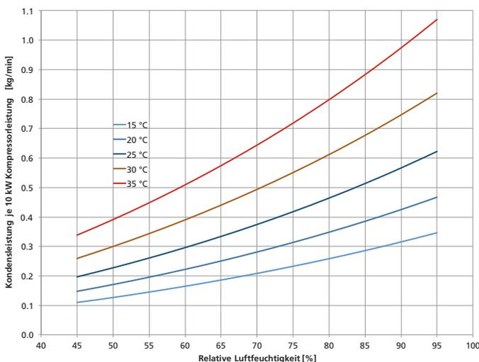
Abb. 18: Kondensleistung von Entfeuchtern in Abhängigkeit von Temperatur und Luftfeuchtigkeit.
