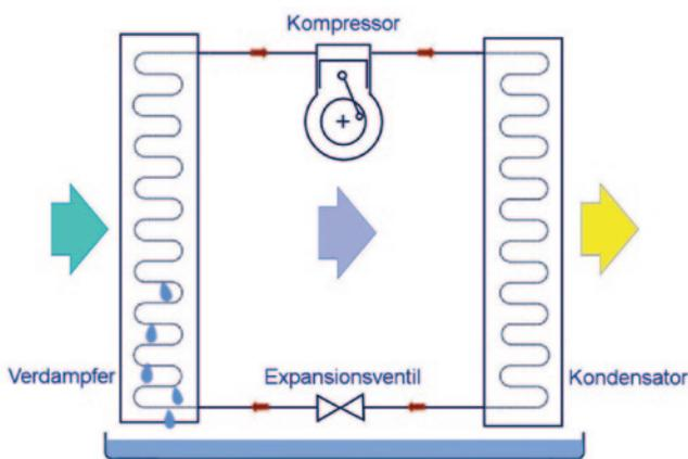
Abb. 17: Schema eines Luftentfeuchters (Luftfluss s. Pfeile).
