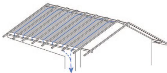
Abb. 9: Sonnenkollektor (Dachabsaugung) bei Sparrendach mit traufseitigem Sammelkanal.
