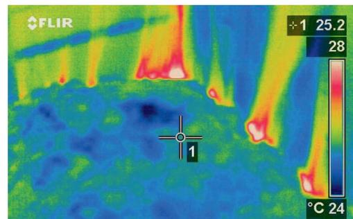
Abb. 22: Das Thermografie-Bild zeigt, dass warme Luft entlang den Wänden der Box entweicht (rote und gelbe Partien).
