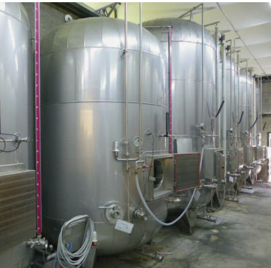
Abb. 2: Die zweite Gärung des Prosecco erfolgt in Drucktanks, den «Autoclavi».
