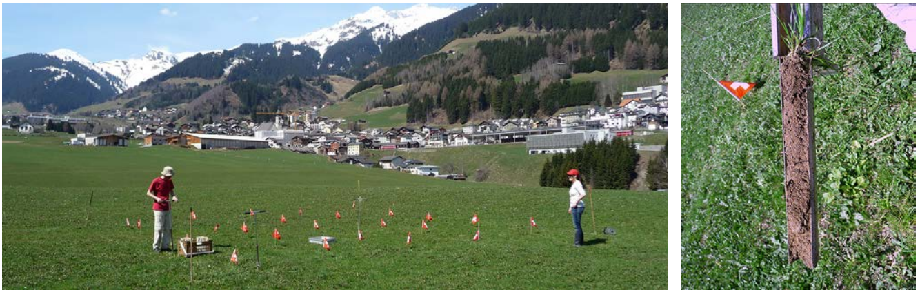
Abb. 3 > Probenahme der Flächenmischproben (4 Proben à je 25 Einzeleinstichen) am Standort Disentis GR sowie Einzeleinstich 0–20 cm
