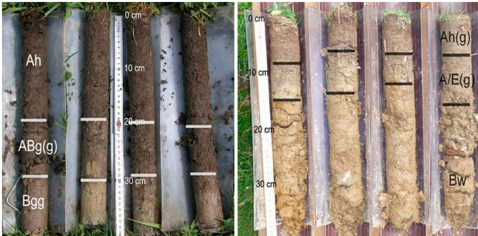
Abb. 33 > Bohrkerne (0 bis 40 cm Tiefe) mit Bezeichnungen der Bodenhorizonte für die Graslandstandorte Entlebuch (intensiv genutzt; links) und Elm (extensiv genutzt)
