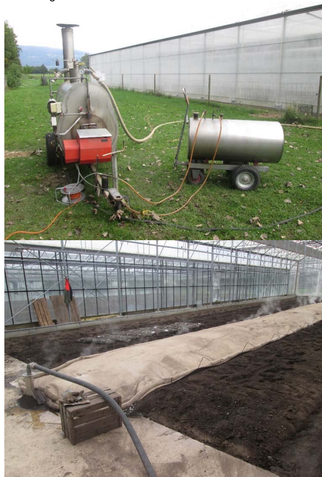
Abb. 1: Der Dampf wird in einem mobilen Kessel erzeugt (oben) und dann unter einer Folie in den Boden injiziert (unten).
