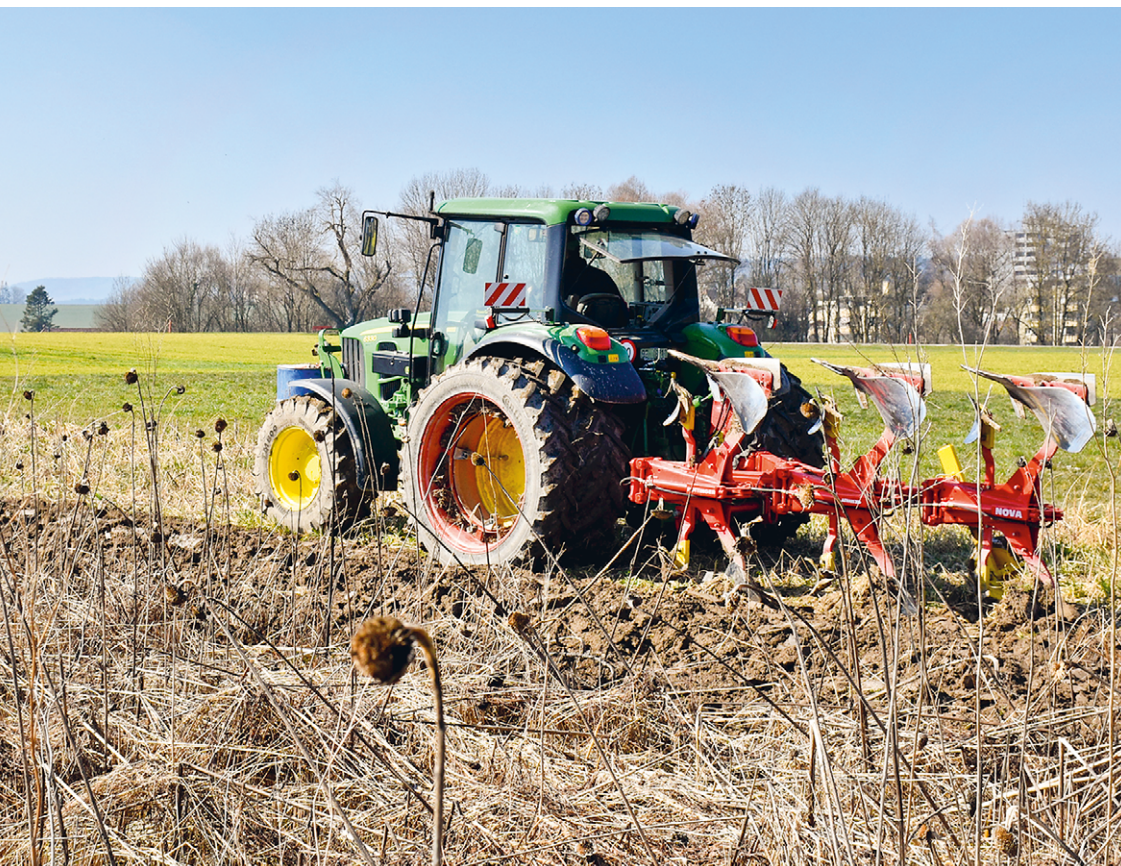
Abb. 1 | Das Pflügen lockert zwar den Oberboden, verdichtet aber untere Bodenschichten – auch bei flachem On-Land-Einsatz. (Foto: Liv Kellermann, HAFL)
