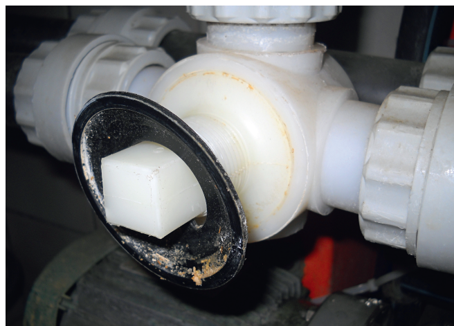
Abb. 13: Bei Stallvisiten entdeckte hygienische Schwachstellen in Melkanlagen. Bild links: Sammelstück mit Ablagerungen. Bild rechts: Dreiweghahn mit Milchrückständen.
