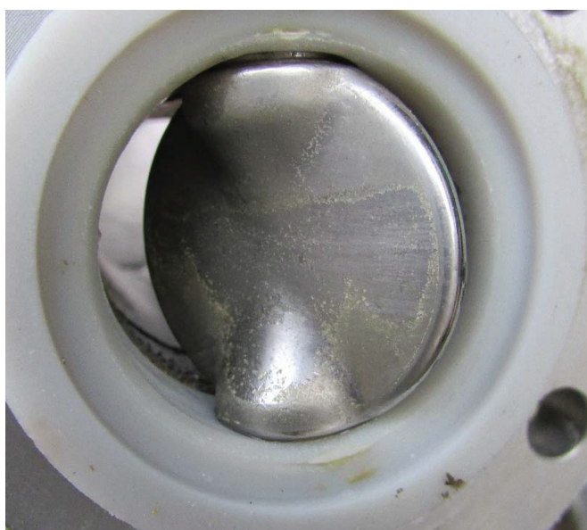
Abbildung 4: Ablagerungen beim Klappenventil eines Milchsammeltanks.
