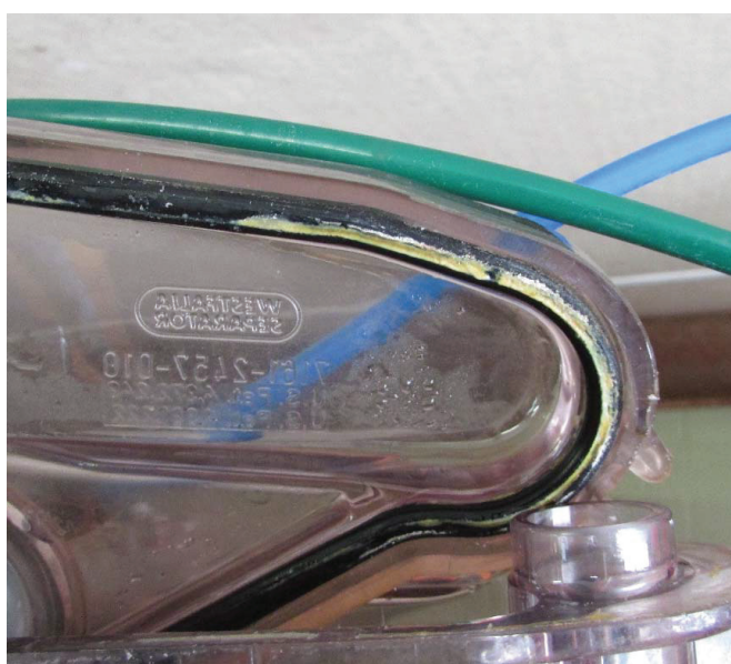
Abbildung 3: Ablagerungen in einem Milchmengenmessgerät durch eine Propionsäuregärung.
