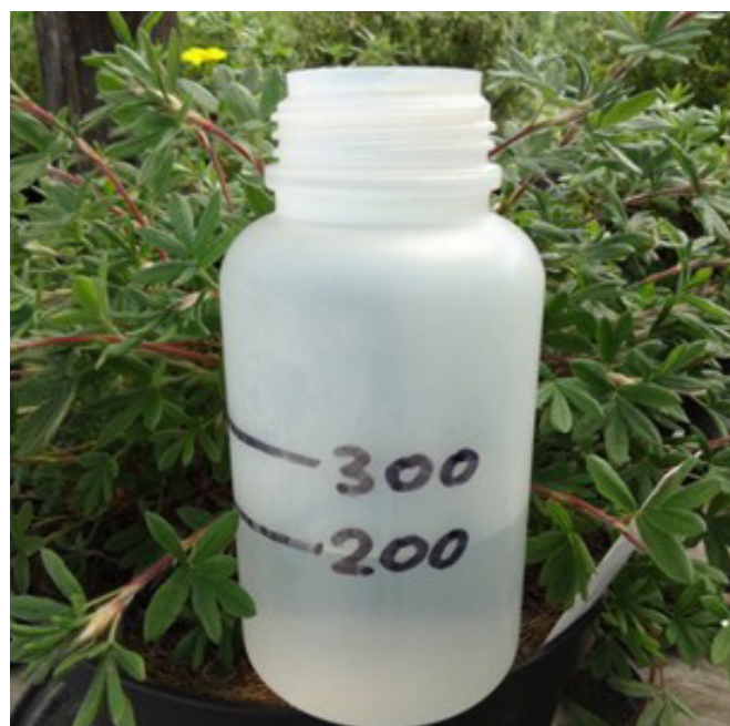
Abbildung 4 | Verschliessbares Schüttelgefäss mit Markierungen bei 200 ml und 300 ml zur Bestimmung des pH-Wertes und des EC-Wertes eines Substrates (Foto: Josef Poffet, Jardin Suisse).
