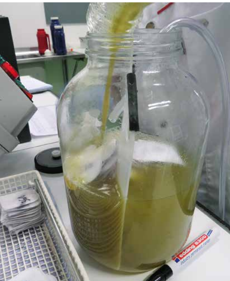
Introduction du jus de panse dans le flacon contenant les sachets et les substances tampons sous ambiance CO 2 . (Photo: Agroscope)
