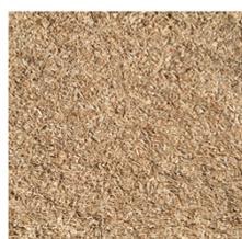
**Weichholz-Granulat** entsteht aus thermisch und mechanisch behandelten Weichholzspäne
