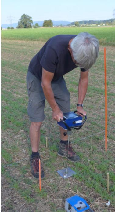
Für die Messungen mittels Penetrologger von Eijkelkamp wurden bei den ersten Messungen in den Flächen R115 und R109 F1 eine Sondenspitze mit einer Fläche von 3.3 cm<sup>2</sup> verwendet. Bei der Methodenvergleichsprüfung in der Fläche R109 F2 wurde zusätzlich eine Spitze mit 1 cm<sup>2</sup> Fläche eingesetzt. Beide Sondenspitzen haben einen Konuswinkel von 60°.
