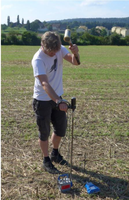
Für die Messung mit der PANDA-Sonde (PANDA2 von Sol Solution) kamen bei allen Messungen Spitzen mit 4 cm<sup>2</sup> Querschnittsfläche und 90° Konuswinkel zum Einsatz. Mit diesem Sondenspitzen-Querschnitt ist die Mantelreibung des Gestänges sehr gering.
