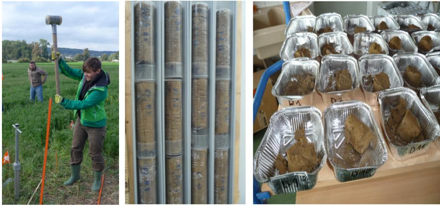
Abbildung 3: Bestimmung des gravimetrischen Wassergehaltes 0 bis 75 cm.
