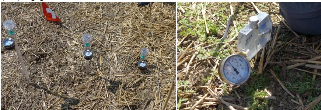
Abbildung 4: Messung der Wasserspannung mit Standard-Tensiometer (links) und Instant-Tensiometer (rechts).
