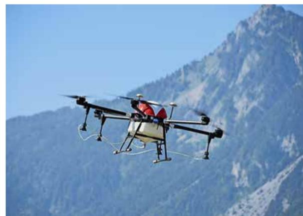
Les drones sont équipés de buses coniques, recouvertes de capuches. Le réservoir a une contenance de 15 litres.
